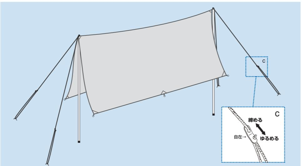
2で配置した張り綱の、末端(上記イラスト○部分)付近の地面にベグをしっかりと打ち込み、張り綱を掛けます。幕体後方にハトメがついているので、同じようにポールの先端を差し込み、ループ状に結んだ張り綱を掛けます。ポールを立ち上げ、張り綱の長さを自在で調節しながら、ポールと幕体をしっかりと自立させます。
