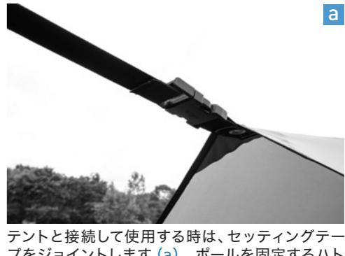
テントと接続して使用する時は、セッティングテープをジョイントします(a)。ポールを固定するハトメの位置(50cm間隔・4箇所)を変えることで、接続するテントとの距離を調整できます。
