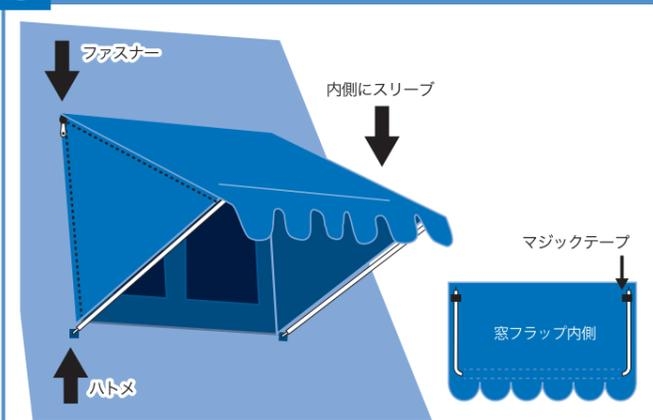
窓フラップの両サイドにあるファスナーを開きます。窓フラップ内側下方にあるスリーブにポールDを通して、両端をハトメに差し込みます。(窓フラップが中央に来るように調節して下さい) ※窓フラップを閉じる場合は、ポールDの端部をハトメからはずして、上向きにします。窓フラップのサイドにあるマジックテープでポールDを固定してファスナーを閉じます。
