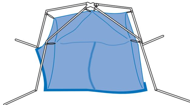
内幕に取付けられたフックをフレームに引掛けます。頂上部は、向かい合うポールにフックを掛けます。四箇所のコーナー部は、一節目と二節目の継ぎ部分の二節目上部に引掛けます。
