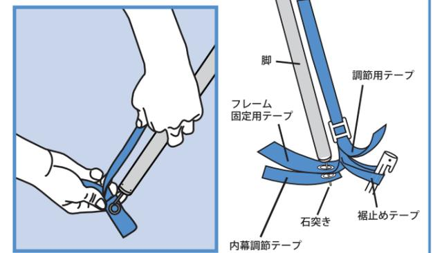
フレームの三節目をそれぞれ接続し、テントを立ち上げます。各フレームの石突き部分に、内幕と外幕の調整テープを取付けます。外幕の張り具合をテープで調節します。※内幕はまだゆるめた状態のままにしてください。
