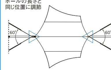
はじめに△印の箇所にジョイントを接続したポールを配置します。ポールの先端部をタープの前方側のリングと後方側テープのハトメに差し込みます。次に張り綱(長)の一端をループになるように結び、ポールの先端に2本づつ引っ掛けでおきます。
