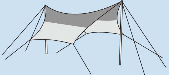
側面の裾部のリングにも短い張り綱を1本ずつ結びつけペグで固定します。ペグはコーナーの対角線の延長線上で、幕体に一番シワのない位置に打ち付けます。全て固定したら張り綱の長さを再度調整し完成です。
