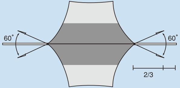
ポールの全長の3分の2の距離でポールを中心にして60度の角度の場所にペグを打ち込みます。
