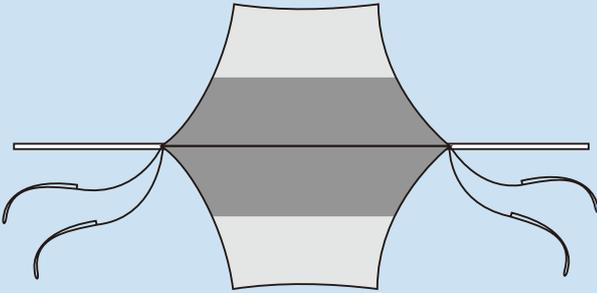
接続したポールを幕体中心の延長線上に配置します。このときに、張り綱をリング部に結び付けます。ポールの先端が入る部分には長い張り綱を2本ずつ結び付けてください。
