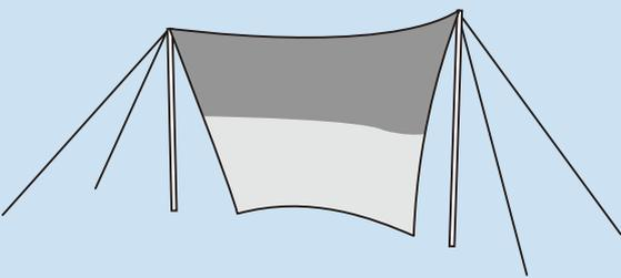
ポールがまっすぐ立つように片側ずつ張り綱の長さを調節しながら立てていきます。逆側も同じように立てます。このとき先に立てたほうを誰かが支えておくようにします。2本とも立ったらロープの長さを再度調節します。
