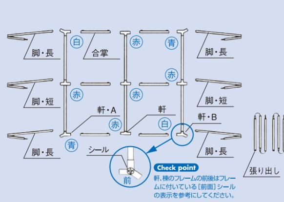
平らな場所を選び整地します。次にフレームを地面に配置します。この時、軒A、軒Bと棟はそれぞれ接続部をつなぎ、前後を間違えないように配置してください。
