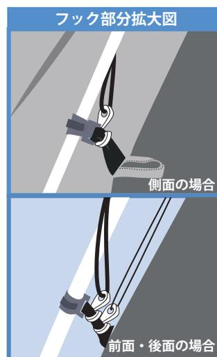
伸縮性のコードは、ボールに巻きながら、非伸縮性(前面・後面のみ)のもの巻きつけず自在で長さを調節してフックをかける。
