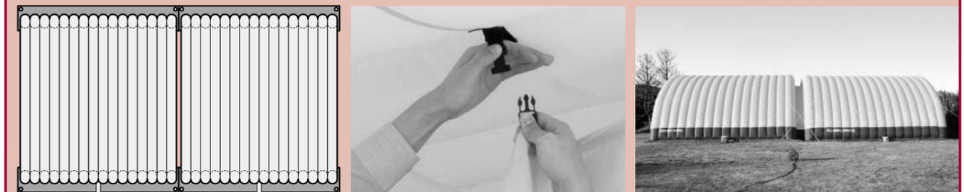
**c 連棟する場合** エアチューブテントを並べて広げます。付属の連棟用シートのバックル(♂)をエアチューブテントに付いているバックル(♀)とそれぞれ接続します。接続完了後、エアチューブテントへ送風を開始します。
