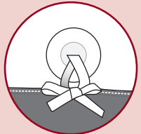
四隅を縛りテープで支柱、中支柱 ※1 に固定します。
