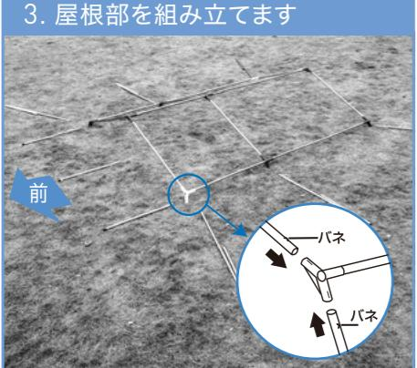
まず、屋根部を組み立てます。軒A、棟、軒Bをそれぞれ合掌でつないでいきます。合掌に付いているバネをジョイントの穴にしっかりと差し込みカチッと音がするまで回してください。
