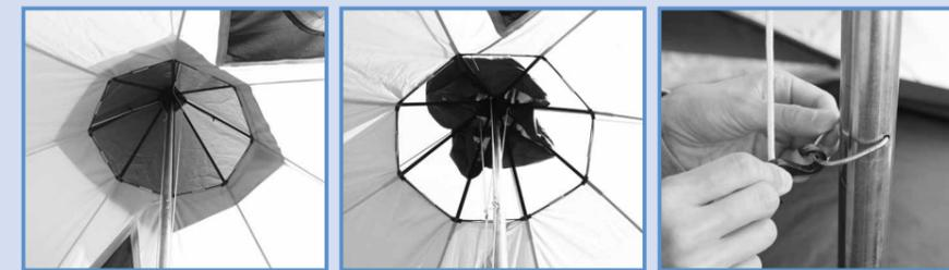
頂上部のベンチレーターはロープの操作により開閉することが可能です。2本のロープに付属するフックをポールのリングに引っかけて固定し、自在を利用してロープの長さを調節して開閉の調整をします。通常はベンチレーターは閉じた状態ですが、ロープを引く(短くすると)ベンチレーターが開きます。(ピルツ23は頂上部のベンチレーター下部にメッシュパネルを装備しています。)
